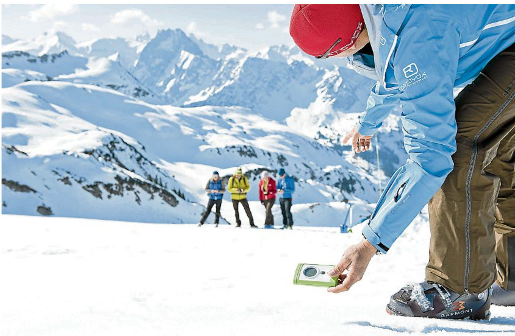
Wie funktioniert die LVS-Suche? Nur mit modernen Digitalgeräten lassen sich Verschüttete schnellstmöglich in einem Lawinenabgang orten. Um im Wettlauf gegen die Zeit eine Chance zu haben, müssen die Handhabung von LVS, Sonde und Schaufel regelmäßig geübt werden. FOTO: CHRISTIAN BRECHEIS / ORTOVOX
